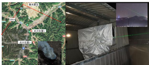
图7 激光雷达安装位置及现场照片
