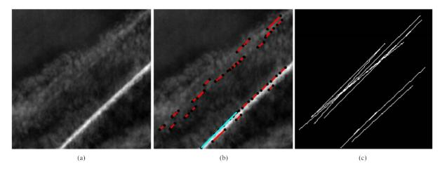
图 2 (a) 原图; (b) 检测边缘不连续现象; (c) 合并相同参数的检测边缘
