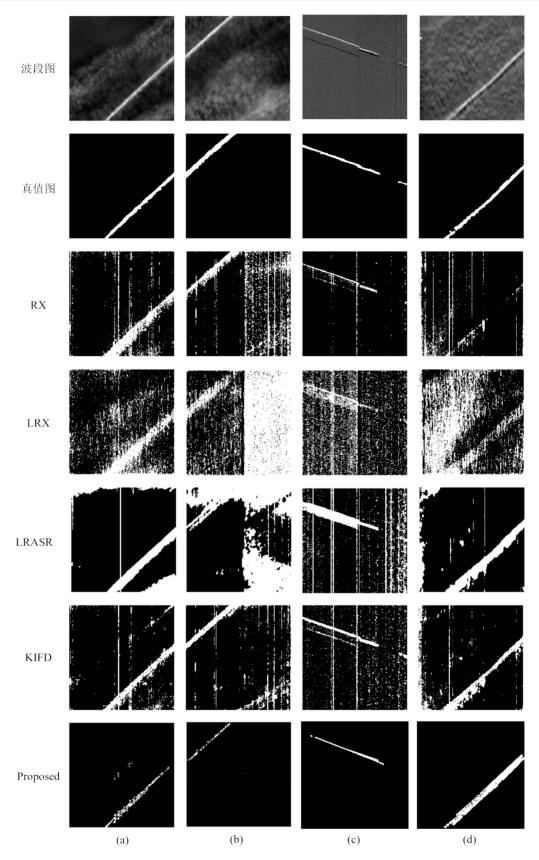
图 9 对比试验结果: (a)Sence 1: GF-5 SWIR (薄云背景). (b) Sence 2: GF-5 SWIR (非均匀性干扰). (c) Sence 3: GF-5 SWIR (海背景). (d) Sence 4: GF-5 SWIR (厚云背景)
