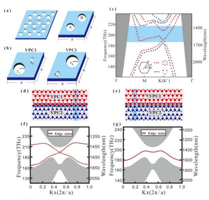
图 2 结构参数示意图和光子能带图:(a)初始光子晶体结构参数示意图。平行四边形表示由两个空气孔(A和B)组成的蜂窝晶格,其中晶格常数  $a=0.44~\mu m$ , 圆半径  $r=0.08~\mu m$ , 硅基板厚度  $h=0.22~\mu m$ ;(b) VPC1(左)和 VPC2(右)的结构示意图;(c)初始蜂窝 PC(红色虚线)和 VPC1(蓝色虚线)的光子能带图,蓝色矩形区域为带隙,灰色阴影为空气锥;(d)和(e)由 VPC1和 VPC2组成的锯齿形和胡须形边界的几何形状,;(f)和(g)由 VPC1和 VPC2组成的锯齿形和胡须形边界的边缘状态能带图,所用的超元胞为(d)和(e)中的蓝色矩形区域。
