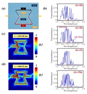
图 3 能谷光子晶体 MZI 结构及光路示意图、透射率光谱曲线及电场强度分布: (a)能谷光子晶体 MZI 结构及光路示意图 ( $\Delta L = 5a$ ); (b)  $\Delta L = 2a$ , 5a, 7a, 10a 时的透射率光谱曲线; (c) (d)分别为当 $\Delta L = 5a$  时, MZI 在 1491.88 nm 和 1484.25 nm 处的电场强度分布 (相应位置已在图 b标出)。
