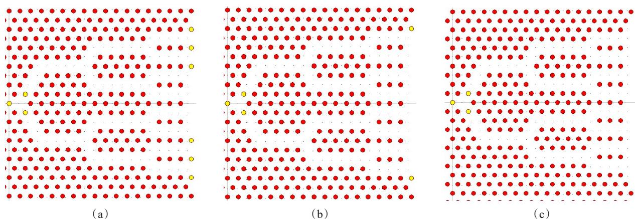
图 5 调整后的出射端结构:(a) 6 个介质柱;(b) 2 个介质柱;(c) 0 个介质柱
