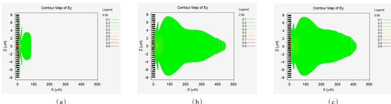
图6 优化后结构的出射光集束仿真:(a) 6个介质柱;(b) 2个介质柱;(c) 0个介质柱
