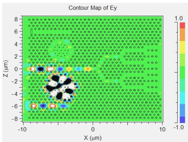
图10 1.510  $\mu\text{m}$ 波长滤波结构光场分布
