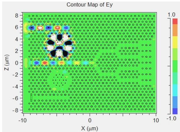
图9 1.490  $\mu\text{m}$ 波长滤波结构光场分布
