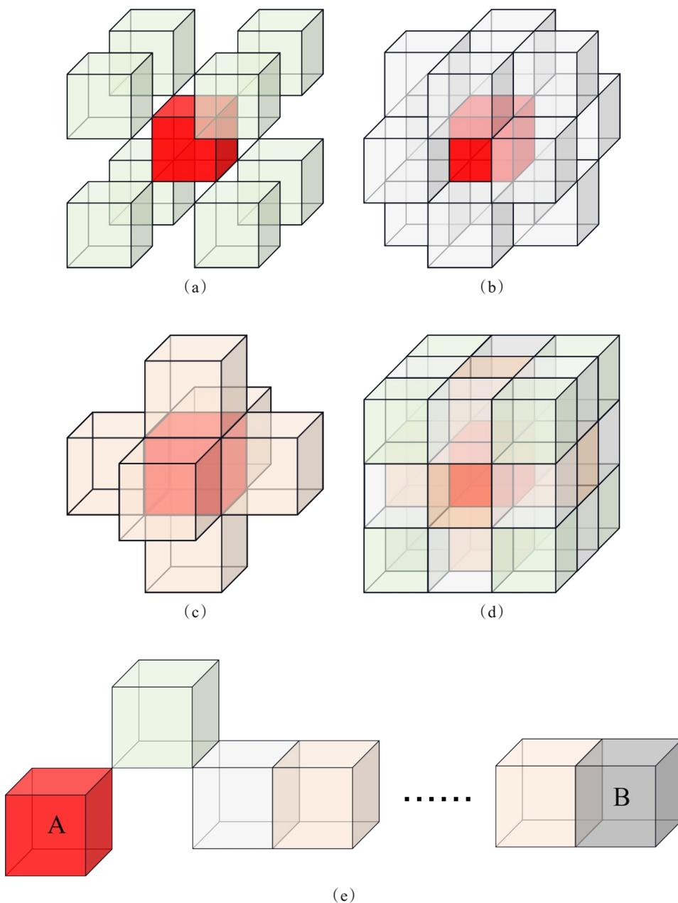
图1 体素拓扑关系特征示意图:(a)体素顶点与顶点的邻接关系;(b)体素边与边的邻接关系;(c)体素面与面的邻接关系;(d)体素全部的邻接关系;(e)体素连通示意图
