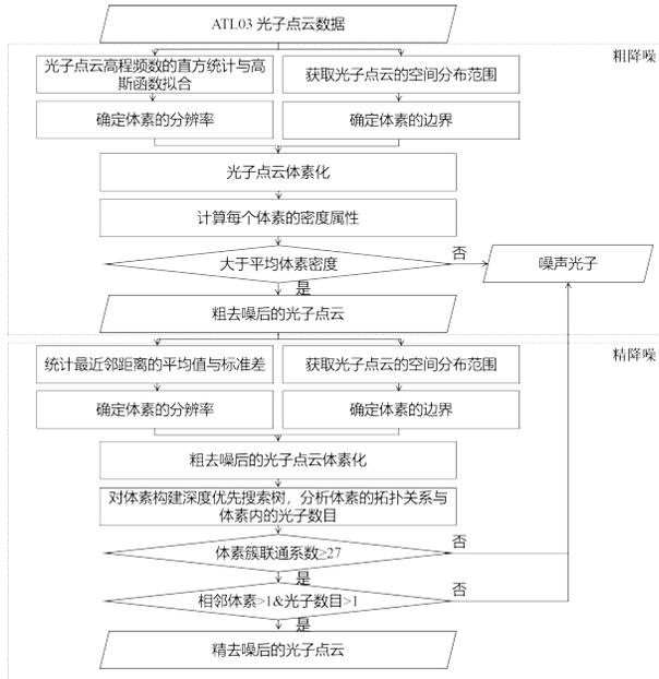
图2 利用两级体素的光子点云自适应降噪算法流程图
