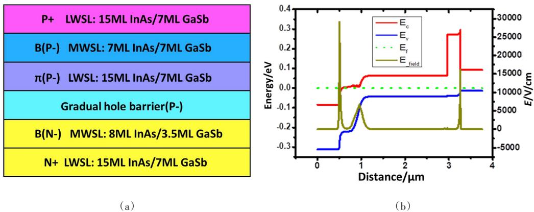
图1 长波超晶格探测器器件结构及其对应的能带结构图:(a)器件结构;(b)对应的能带结构图
