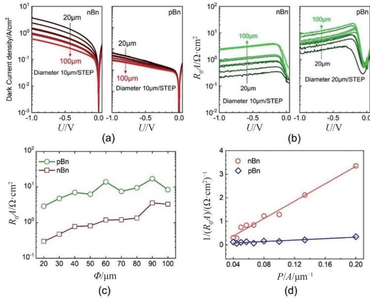
图3 20~100  $\mu\text{m}$  直径的nBn和pBn器件于室温下的(a)暗电流密度和电压变化曲线和(b)  $R_{\phi}A$  随反向偏压的变化曲线;(c) 在400 mV反偏时,pBn和nBn器件  $R_{\phi}A$  随台面直径的变化;(d)  $(R_{\phi}A)^{-1}$  与周长对面积( $P/A$ )的变化曲线
