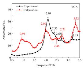
图 3 PCA的THz实验吸收谱与理论计算结果
