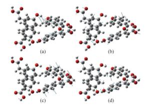
图 6 PCA 在 (a) 2.00 THz; (b) 2.46 THz; (c) 2.71 THz; (d) 3.32 THz的振动模式
