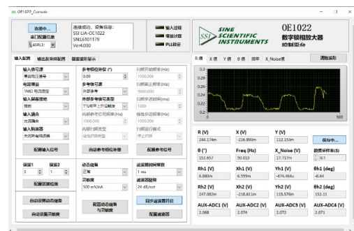
图18 锁相放大器显示的太赫兹探测响应波形
