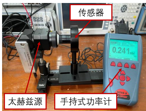
图 15 太赫兹信号源的功率测定 Fig. 15 Terahertz source power measurement
