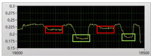
图19 对不同隔挡物(A4纸和铜板)的透射结果
