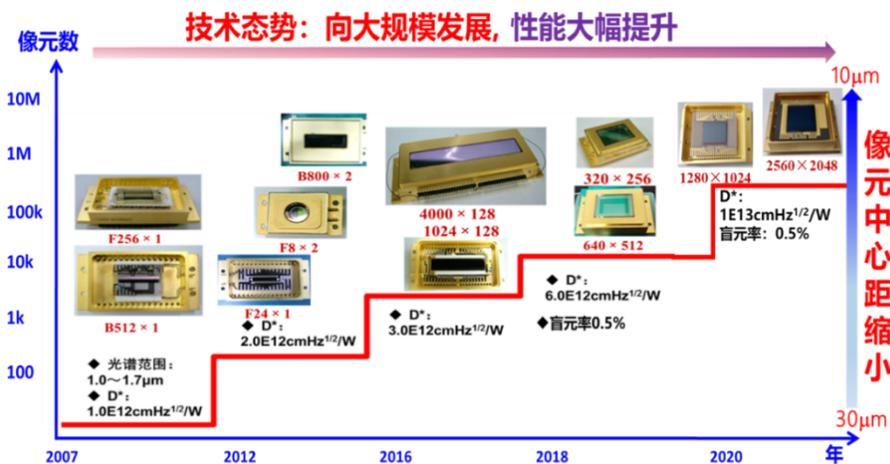
图 1 上海技物所  $1.0 \sim 1.7 \mu\text{m}$  InGaAs 常规波长焦平面探测器发展
