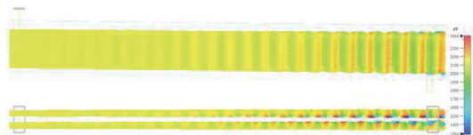
Fig. 6 Electron bunching above the SDMMML SWS 图6 悬置双微带曲折线慢波结构的电子群聚图
