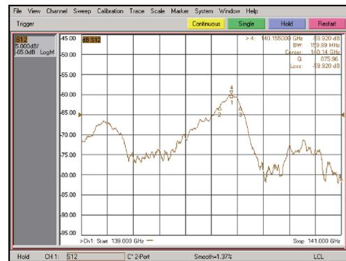
图13  $TE_{28,8}$ 模谐振频率和 $Q$ 值的测量
