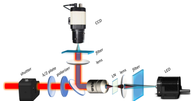
图 1 实验光路示意图,铌酸锂晶体(LN)固定在三维可移动平台上(图中未画出)
