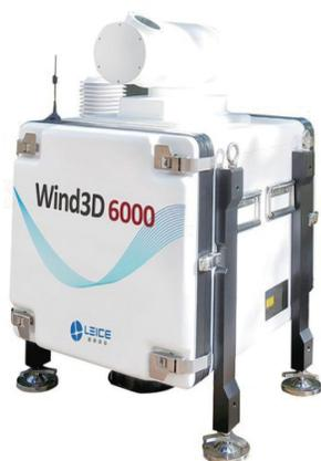
图1 Wind3D 6000 航空气象型测风激光雷达
