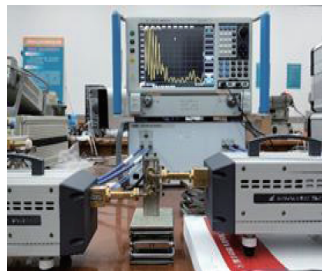
Fig. 12 Test site of the CC-TWT circuit 图12 耦合腔行波管电路的测试现场
