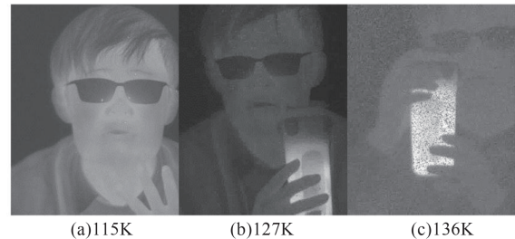
图6 带间级联中波红外焦平面变温成像演示, 工作温度分别为 (a) 115 K, (b) 127 K, (c) 136 K
