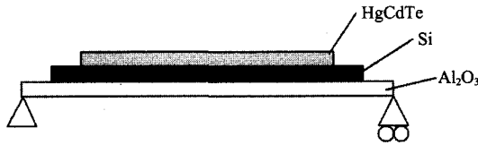
图1 计算热应力的焦平面器件模型
