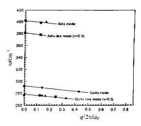
图 4 测量的 AlAs/Al<sub>0.2</sub>Ga<sub>0.7</sub>As 和 GaAs/Al<sub>0.3</sub>Ga<sub>0.7</sub>As 超晶格样品的 LO 模擬率对  $q=\frac{m}{n+1}\left(\frac{2\pi}{a_0}\right)$ 的关系曲线
