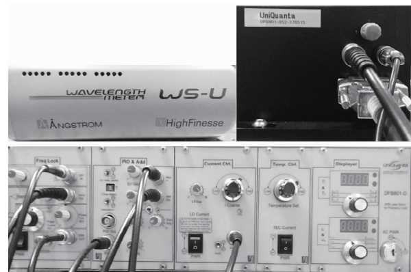
图 3 852 nm(铯)高稳定度基准光源和高分辨率高精度波长计
