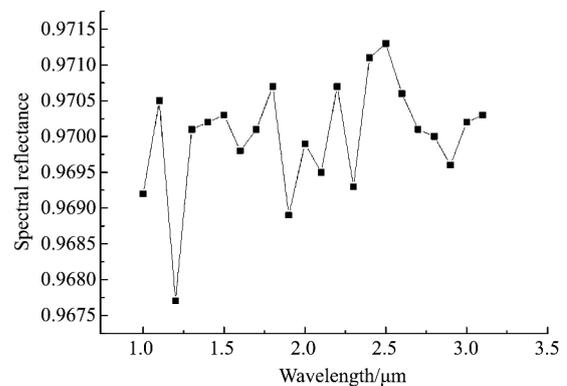
图 2 金层的光谱反射比
