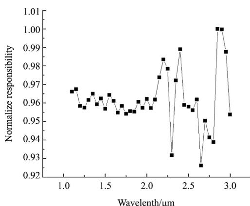
图10 红外陷阱探测器相对光谱响应率
