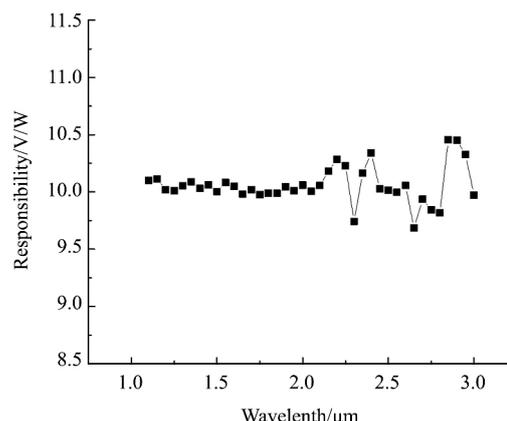
图11 红外陷阱探测器绝对光谱响应率
