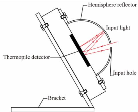
图 1 红外陷阱探测器结构
