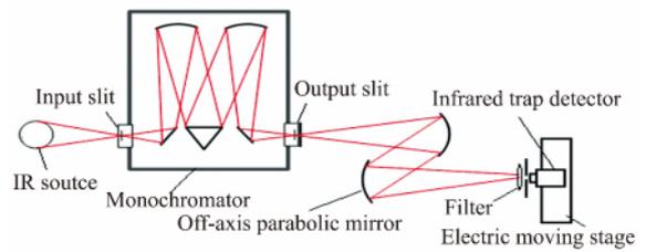
图 7 红外绝对光谱响应定标系统示意图
