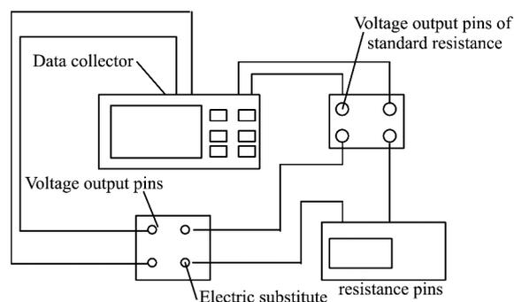
图3 线性测量系统示意图
