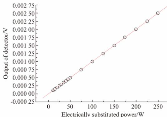
图4 红外陷阱探测器线性拟合图
