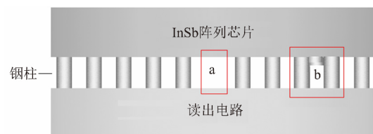
图 4 面阵探测器钨柱缺陷结构示意图
