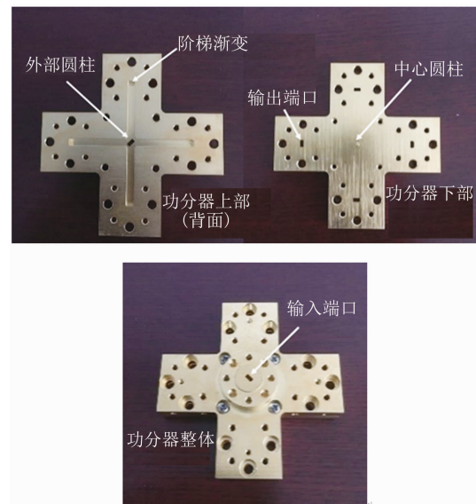
图 3 径向波导功分/合成器实物图 Fig. 3 Fabricated radial-line waveguide divider/combiner
