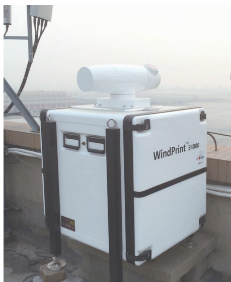
图1 相干多普勒测风激光雷达在北京首都国际机场进行低空风切变观测现场图 Fig. 1 Coherent Doppler Wind Lidar configured at BCIA
