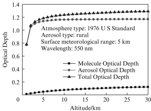
图2 大气光学厚度随高度的变化曲线
