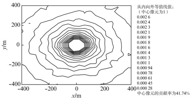
图3 蒙特卡罗法模拟的二维大气PSF
