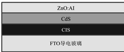
图8 CIS 原型电池基本结构示意图 Fig. 8 Schematic illustration of CIS prototype solar cell structure
