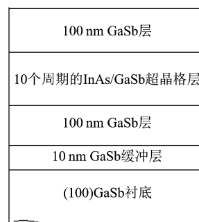
图 3 InAs/GaSb 超晶格结构图 Fig. 3 The diagram of InAs/GaSb SL structure
