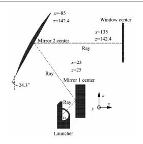
图 3 付拉索夫模式变换器结构图 Fig. 3 Geometric of Vlasov launcher
