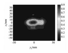
图 5 椭圆抛物镜面上的二维场分布 Fig. 5 Power distribution on the elliptical mirrors
