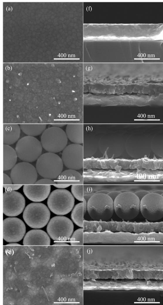
图 2 不同阶段样品的扫描电子显微镜图 (a-e) 俯视图, (f-j) 为截面图。(a,f) 金/铜薄膜样品, (b,g) 金/氧化铜薄膜样品, (c,h) 金/氧化铜/聚苯乙烯小球阵列样品, (d,i) 金/氧化铜/聚苯乙烯小球阵列 + 金薄膜样品 (e,j) 金/氧化铜/金微结构样品
