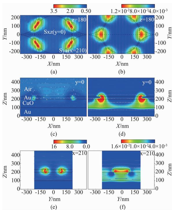
图4 正入射共振吸收波长处电磁场分布图. 左列为电场,右列为磁场. (a,b) 为  $xy$  横截面俯视图( $z = 180$  nm),(c,d) 为  $xz$  纵截面图( $y = 0$  nm),(e,f) 为  $yz$  纵截面图( $x = 210$  nm)
