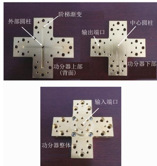
图 3 径向波导功分/合成器实物图
