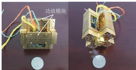
图8 W波段功率合成放大器
