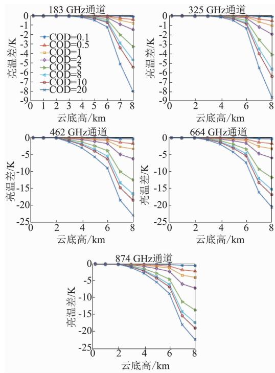
图4 中、低层水云对大气层顶太赫兹辐射光谱的影响
