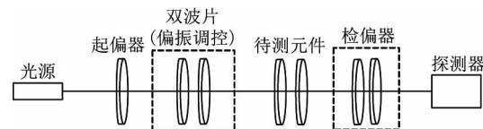
图 1 偏振调制测量系统的光路原理图
