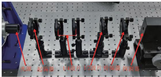
图2 双波片偏振调控测量系统的实验装置图
