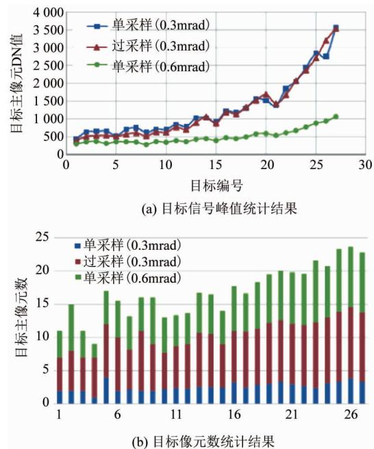
图4 三种采样体制的目标信号采集能力 (a) 目标信号峰值统计结果,(b) 目标像元数统计结果
