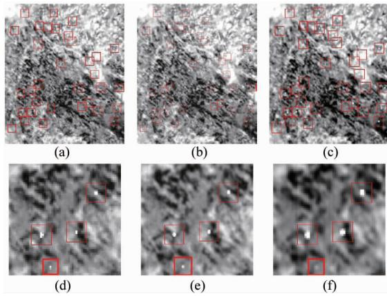
图3 成像仿真结果(a) 0.3 mrad 单采样,(b) 0.3 mrad 过采样,(c) 0.6 mrad 过采样,(d) 0.3 mrad 单采样局部目标,(e) 0.3 mrad 过采样局部目标,(f) 0.6 mrad 过采样局部目标
