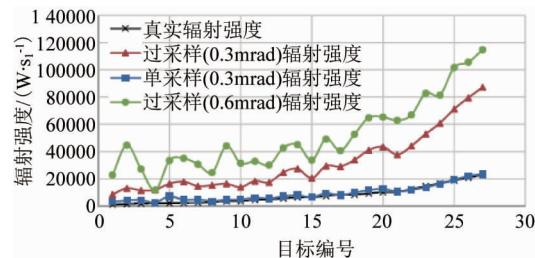
图 9 三种采样体制下的目标辐射强度测量值和真实值
