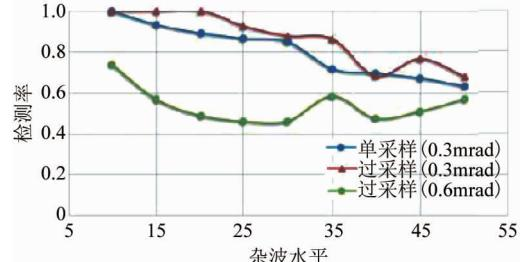
图 7 不同杂波水平中目标的检测率
