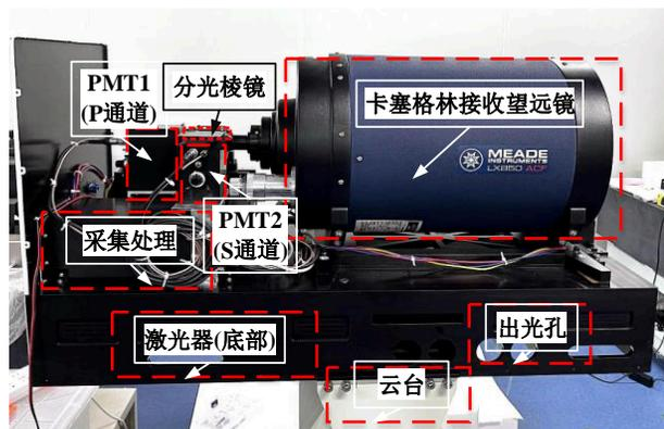
图 1 扫描偏振激光雷达系统
