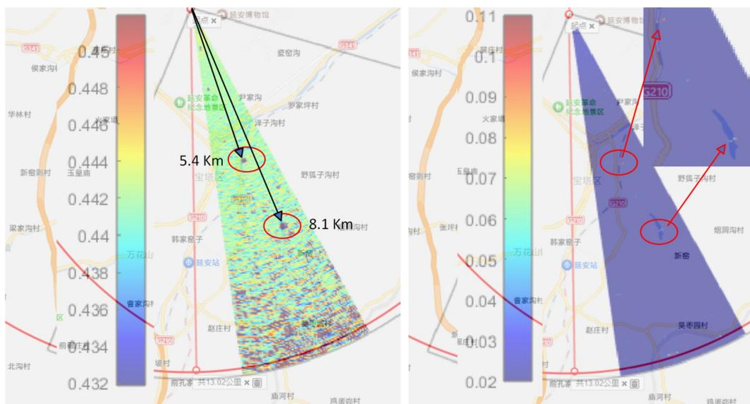
图8 延安模拟点火扫描探测伪彩色图 (a) 消光系数 (b) 退偏比
