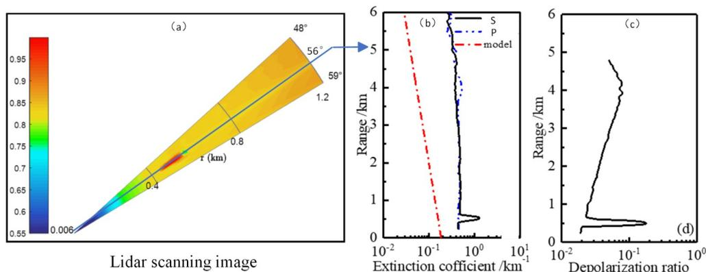
图5 模拟火灾(近场)探测结果:(a) S通道RSCS的PPI图;(b) 56°处的消光系数廓线;(c) 56°处的退偏比廓线
