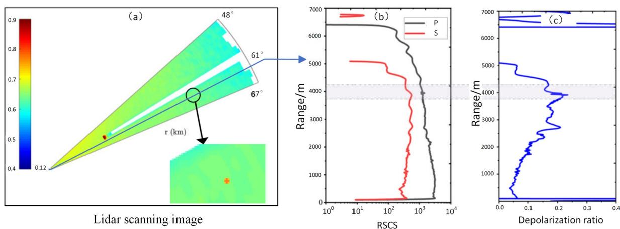
图6 模拟火灾(远场)探测结果:(a) S通道RSCS的PPI图;(b) 61°处的RSCS;(c) 61°处的退偏比廓线
