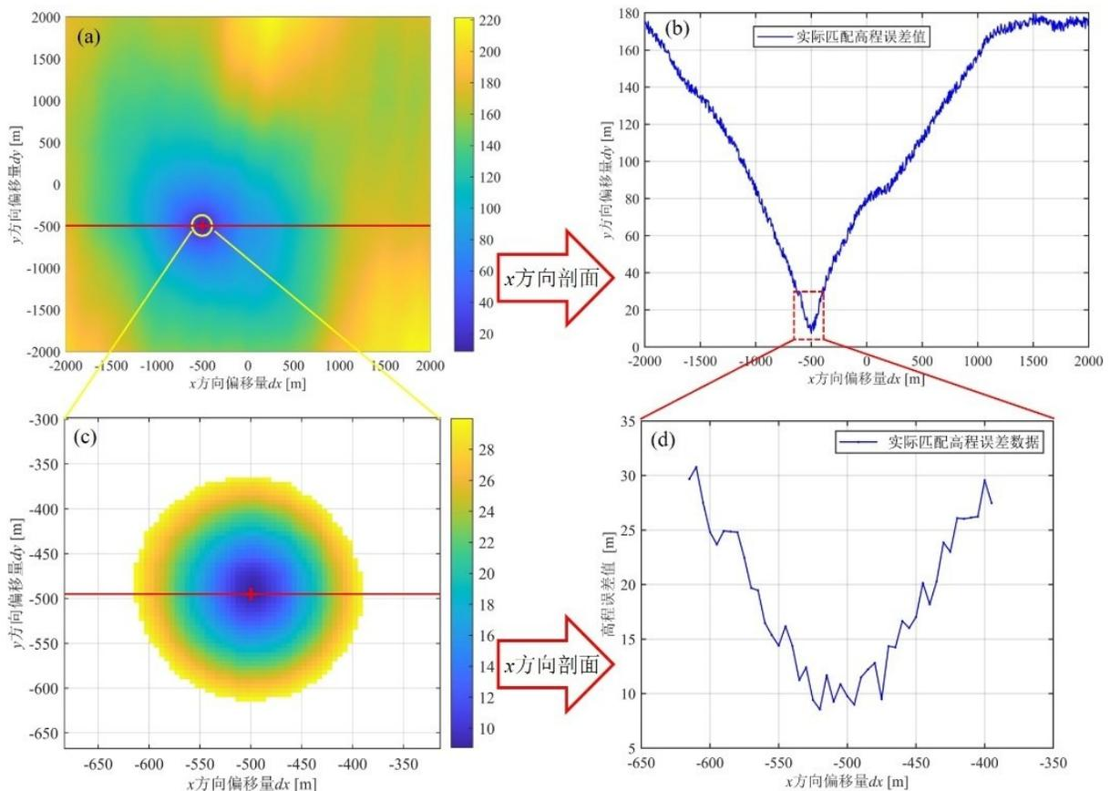
图3 极小值点附近  $x$  方向上实际高程误差分布;(a) 总体高程误差分布;(b) 极小值点处  $x$  方向误差分布;(c) 极小值点附近高程误差分布;(d) 极小值点处  $x$  方向剖面误差分布局部图
