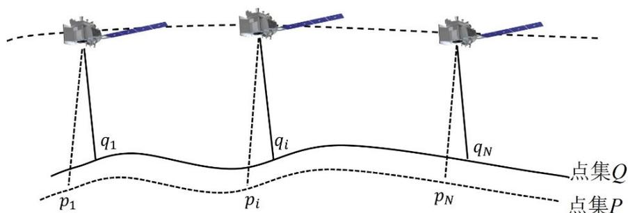
图1 自然地表地形轮廓匹配的实现原理
