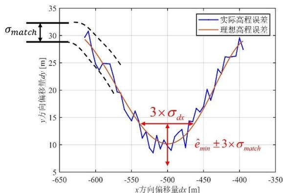
图4 随机误差  $\sigma_{match}$  和高程误差分布趋势对匹配不确定度大小的影响
