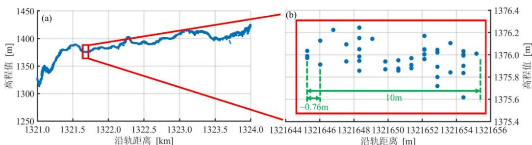
图8 点云数据抽稀中间过程;(a) 3km的未抽稀点云数据;(b) 10m抽稀间隔的局部放大图
