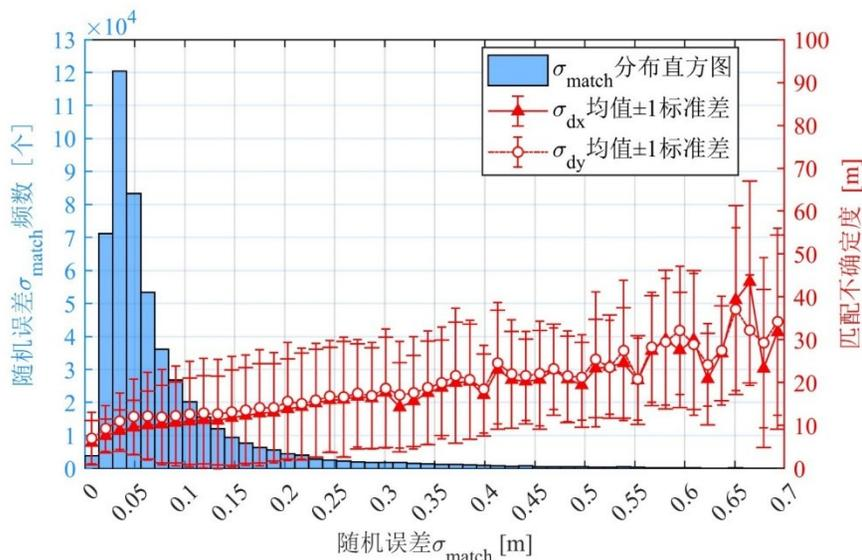
图 19 30m 抽稀间隔下随机误差  $\sigma_{match}$  量级对匹配不确定度大小的影响
