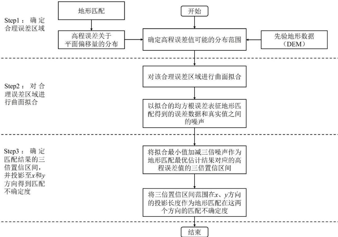
图6 地形匹配不确定度计算流程
