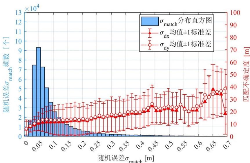
图 20 60m 抽稀间隔下随机误差  $\sigma_{match}$  量级对匹配不确定度大小的影响
