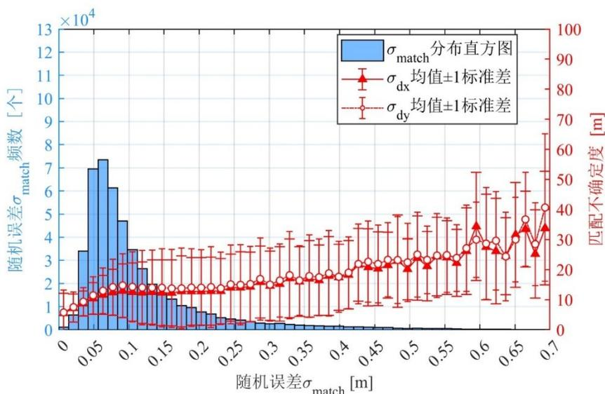
图 21 90m 抽稀间隔下随机误差  $\sigma_{match}$  量级对匹配不确定度大小的影响
