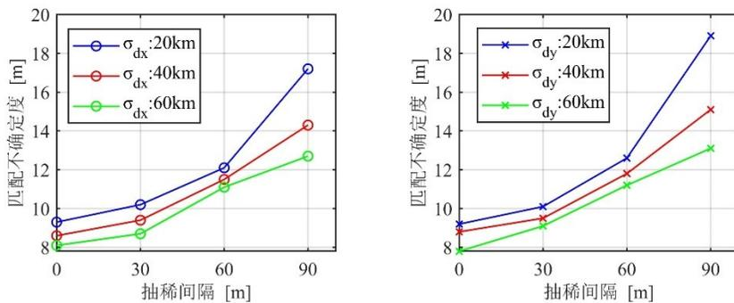
图 13 20km、40km、60km 三种轨迹长度下不同抽稀间隔下的匹配不确定度
