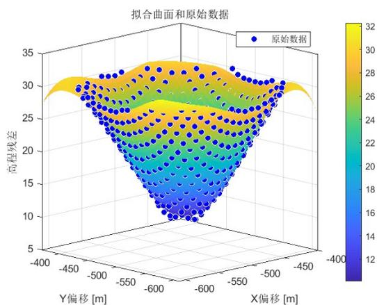
图5 拟合曲面和原始高程误差分布曲面
