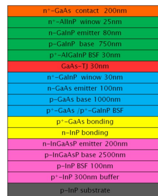
图5 键合三结太阳电池结构示意图
