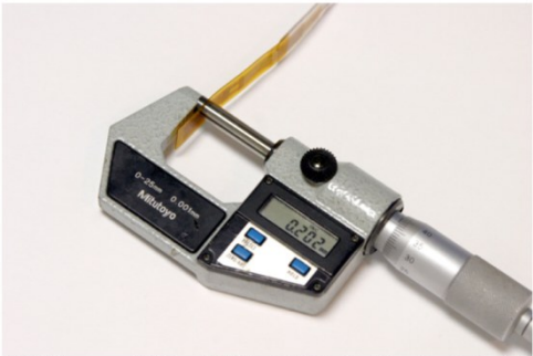
厚度0.2毫米! 可从小间隙测量温度
