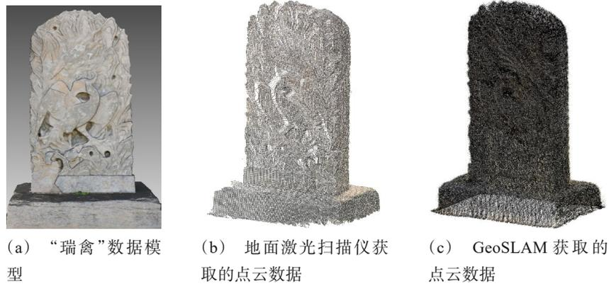
图 3 不同传感器获取的“瑞禽”点云数据
