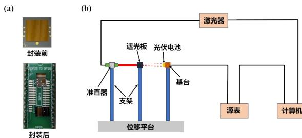
图1 器件封装与测试:(a)封装前后的器件;(b)激光光伏电
