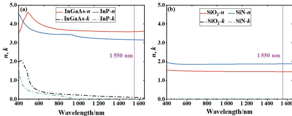
图3 材料光学参数测试:(a)外延InP、In<sub>0.53</sub>Ga<sub>0.47</sub>As薄膜的光学参数(折射率 $n$ 和消光系数 $k$ )随波长的变化关系图;(b)减反层SiO<sub>2</sub>和SiN薄膜的光学参数随波长的变化关系图
