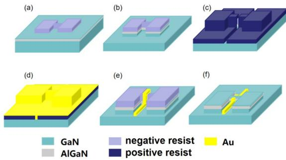
图4 基于自对准工艺制备侧栅流程图
