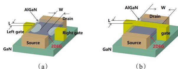
图1 器件结构示意图:(a)侧栅HEMT;(b)传统HEMT<sup>[18]</sup>
