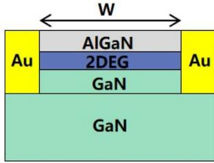
图2 侧栅 GaN/AlGaIn HEMT 原理图
