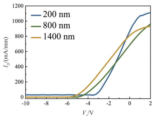
图7 侧栅 HEMT 转移特性曲线
