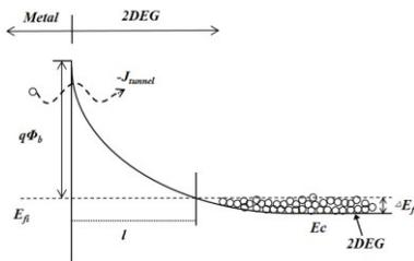
图3 金属与2DEG接触能带图<sup>[19]</sup>
