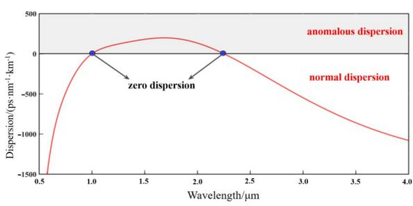
图3 氮化硅夹层波导色散系数图,灰色区域代表反正常色散区,白色区域代表正常色散区
