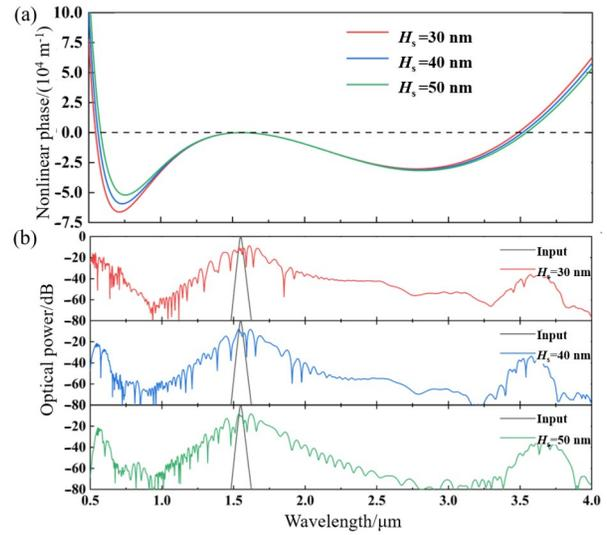
图8 在1 550 nm脉冲,  $W=1\ 800\ \text{nm}$ ,  $H_u=200\ \text{nm}$ ,  $H_t=500\ \text{nm}$ 条件下,不同 $H_s$ 对相位匹配及SCG影响:(a)不同 $H_s$ 条件下氮化硅夹层波导的相位匹配图;(b)不同 $H_s$ 条件下氮化硅夹层波导的SCG谱图
