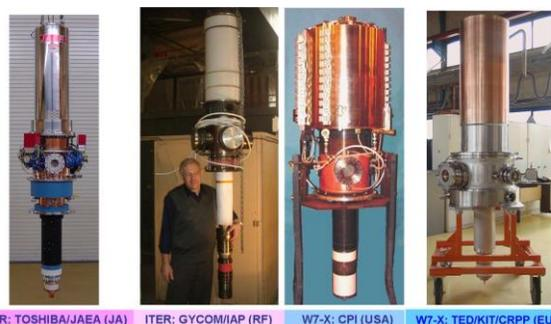
图2 MW级回旋管实物图(日本、俄罗斯、美国、欧洲)
