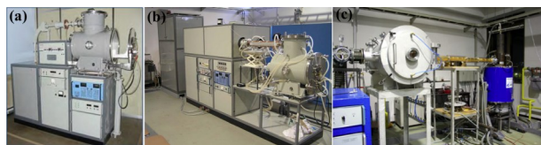
图5 回旋管系统:(a)基于输出频率24 GHz、功率3 kW的紧凑回旋管组装的陶瓷烧结系统;(b)双频率回旋器件应用系统;(c)基于输出频率300 GHz、输出功率3 kW连续波回旋管的材料处理系统
