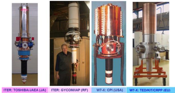
图2 MW级回旋管实物图(日本、俄罗斯、美国、欧洲)
