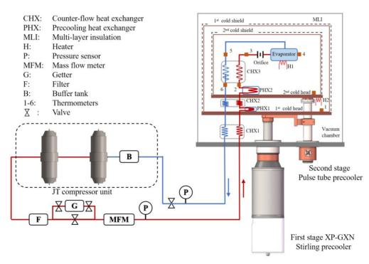
Fig. 1 4.2 K JT cryocooler system 图 1 4.2 K 节流制冷系统图
