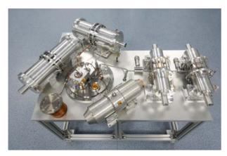
Fig. 10 0.1 W@4.1 K JT cryocooler system experimental setup 图 10 0.1 W@4.1 K 节流制冷系统实验台
