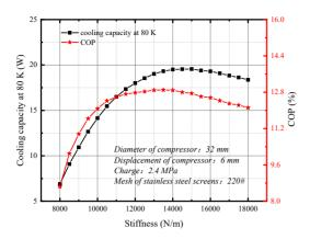
Fig. 5 Effect of mechanical stiffness on Stirling cryocooler 图 5 机械刚度对斯特林制冷机的影响
