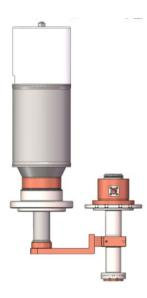
Fig. 2 Structure of the two-stage precooler 图 2 两级预冷结构图
