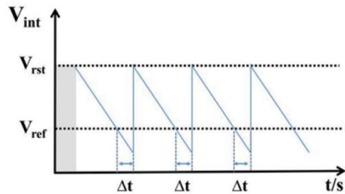
图5 PFM脉冲频率调制结构的延迟
