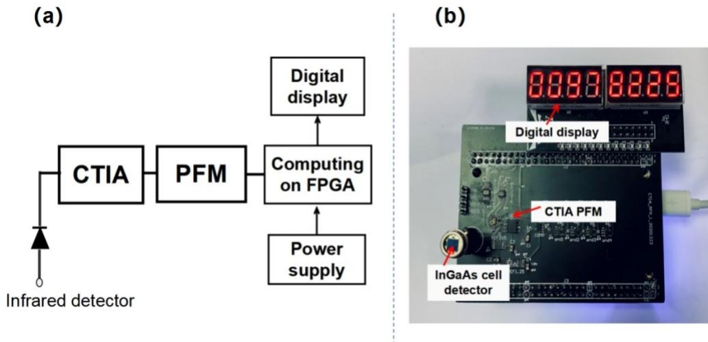
图2 CTIA输入级的PFM脉冲频率调制方法实验原理(a)实验系统结构,(b)系统实物图
