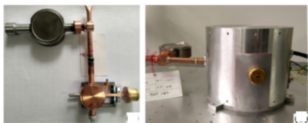
图 33 0.26 THz斜注管加工及装配情况
