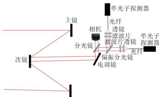
图2 望远镜光路图
