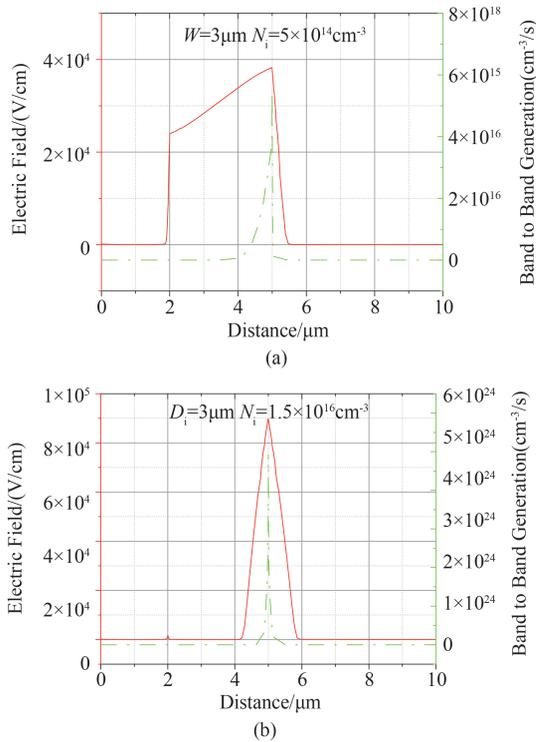
图 3 BBT 产生率与结区场强的关系, I 区参数  $D_i=3\mu\text{m}$ ,  $N_i$  分别取  $5 \times 10^{14} \text{cm}^{-3}$  (a) 和  $1.5 \times 10^{16} \text{cm}^{-3}$  (b) 反向偏压  $V=10\text{V}$
