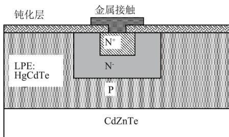
图 1 碲镉汞平面结 APD 器件结构示意图
