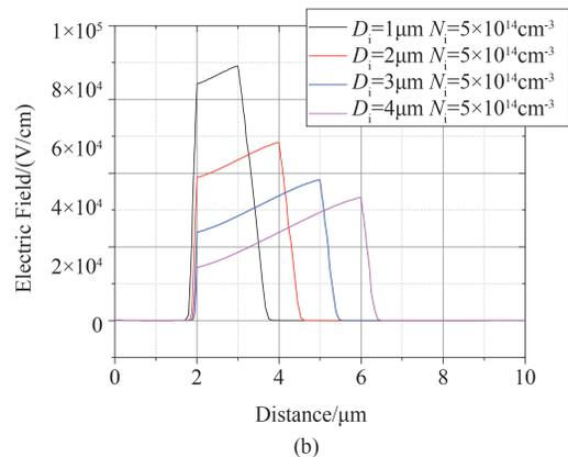
图2 结区场强分布与I区浓度 $N_i$ (a)和I区厚度 $D_i$ (b)的关系,反向偏压 $V=10\text{V}$ ,其中Distance是指外延层的纵向分布
