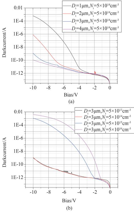
图5 暗电流与I区厚度 $D_i$ (a)和I区浓度 $N_i$ (b)的关系
