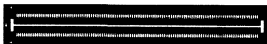
图 3 128 元线列 InGaAs 探测器照片 Fig. 3 Photograph of 128 element linear InGaAs detector array
