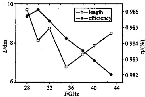
图4 同一波导半径下,频率 $f$ 、变换器长度 $L$ 及效率 $\eta$ 之间的关系
