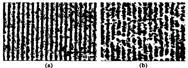
图 2 掺镁铌酸锂周期极化畴结构,脉冲宽度 10ms,脉冲周期 110ms (a) +z 面 (b) -z 面
