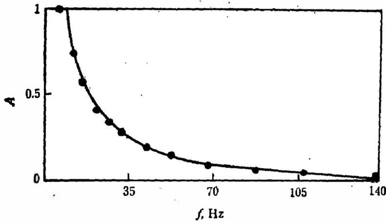
图5 三层样品(NiCuNi)的振幅随频率变化的实验值和计算机拟合值
