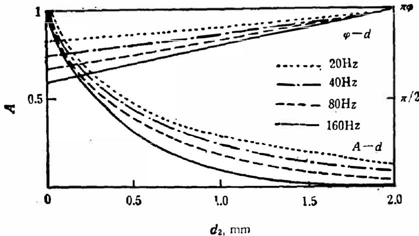
图2 不同频率下归一化振幅和位相随埋层厚度的变化
