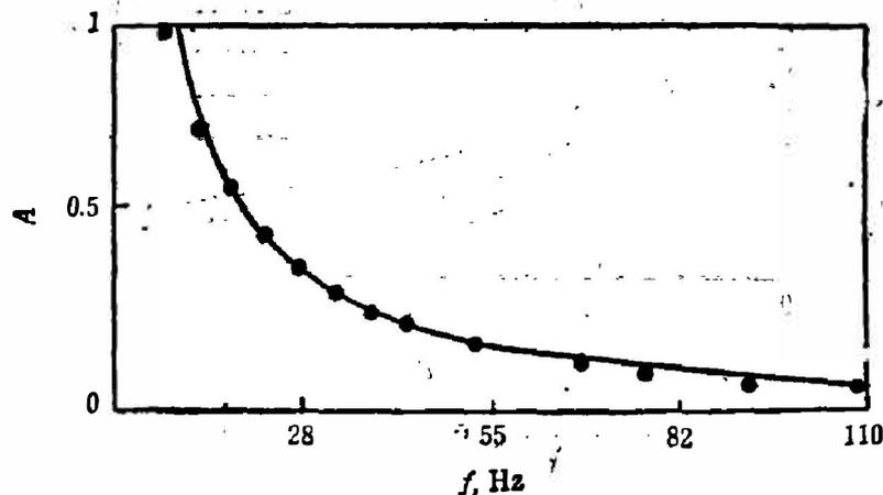
图 4 三层样品(CuAlCu)振幅随频率变化的实验值和计算机拟合值
